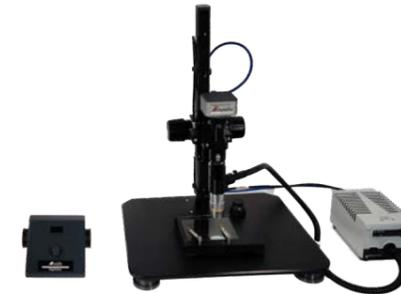
Geringe Umgebungsvibrationen durch umliegende Maschinen, Züge, Transport, Kühlung, Heizung und andere Quellen können oft dazu führen, dass die Proben um einige Mikrometer schwingen, was dazu führt, dass das Bild unscharf aussieht und Messungen ungenau werden, insbesondere bei hoher Vergrößerung.
